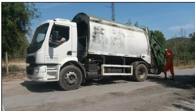
**Figura 34: Caminhão compactador utilizado na coleta convencional**
